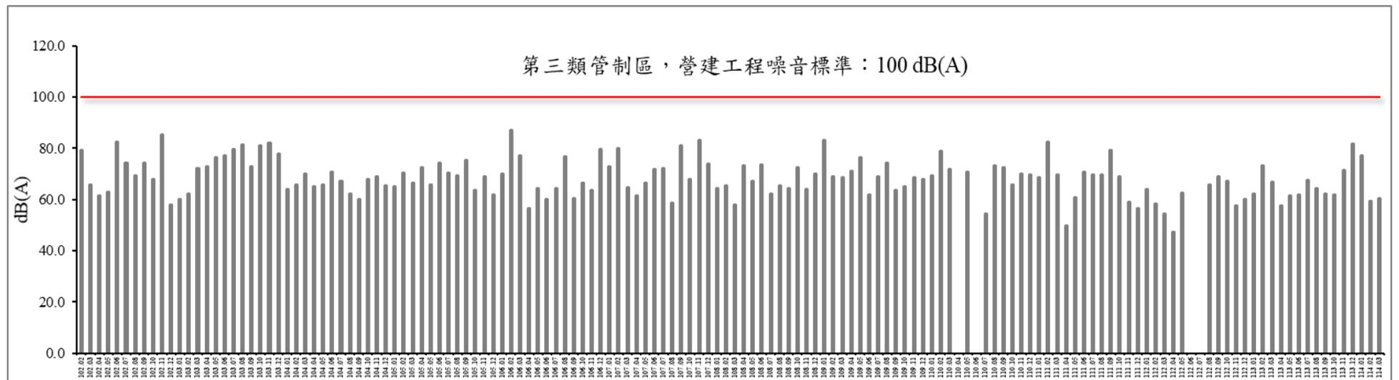
圖 27 歷次營建噪音  $L_{max}$  監測結果比較圖
