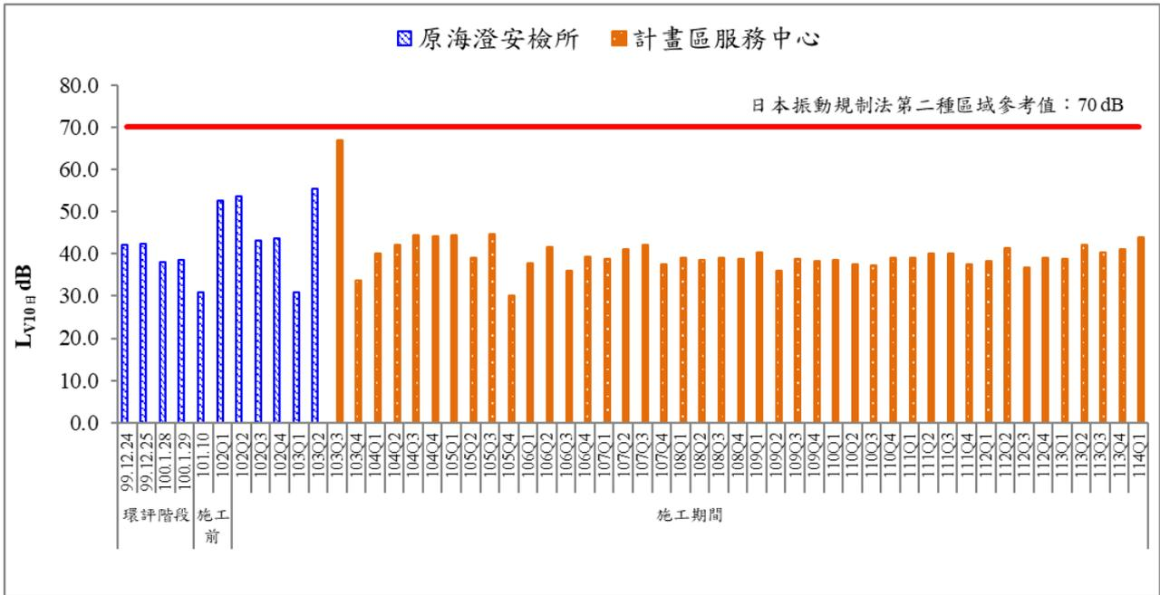
圖 19 歷次日間振動監測結果比較圖(一)
