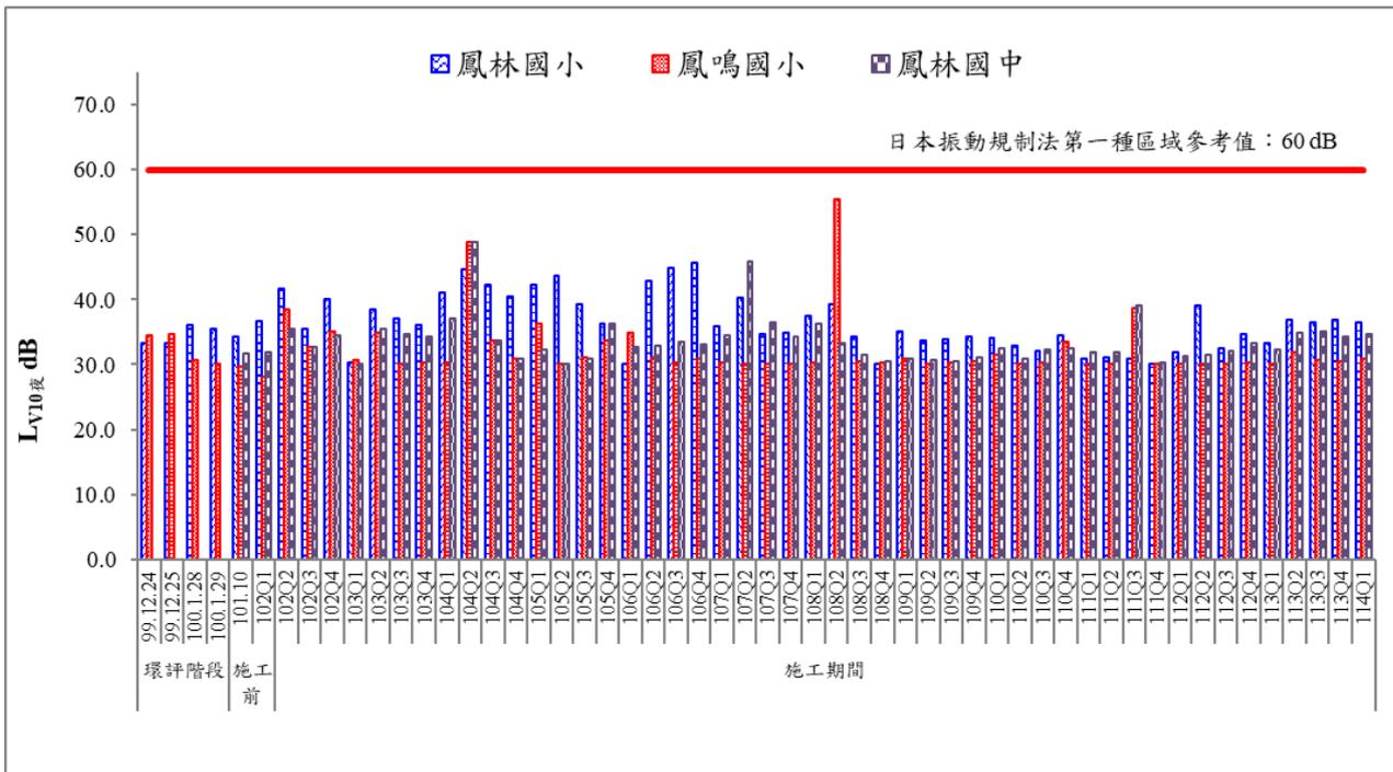
圖 22 歷次夜間振動監測結果比較圖(二)
