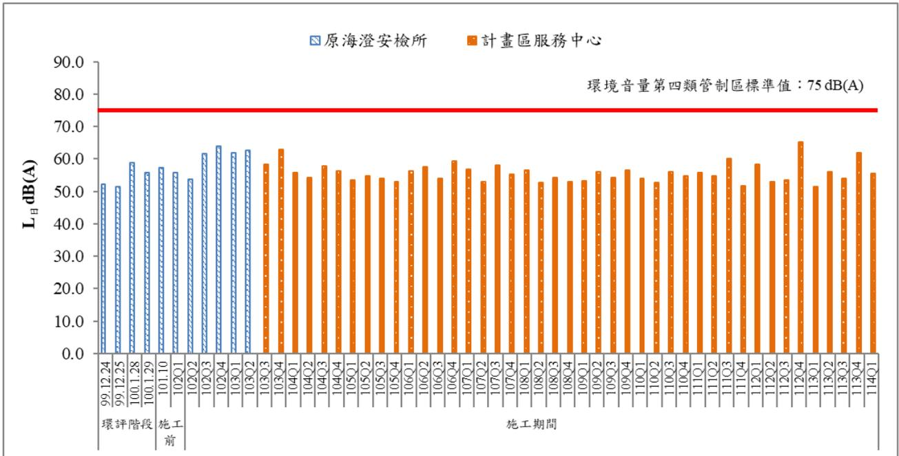
圖 13 歷次日間噪音監測結果比較圖(一)
