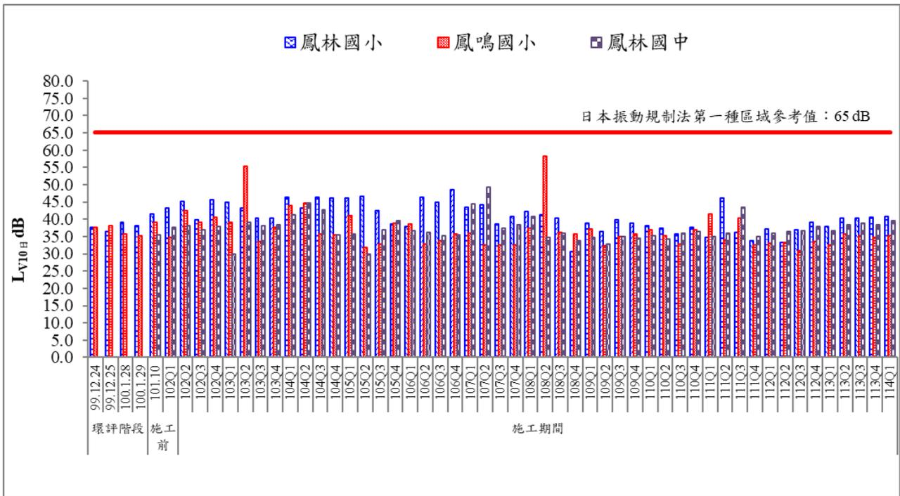
圖 20 歷次日間振動監測結果比較圖(二)
