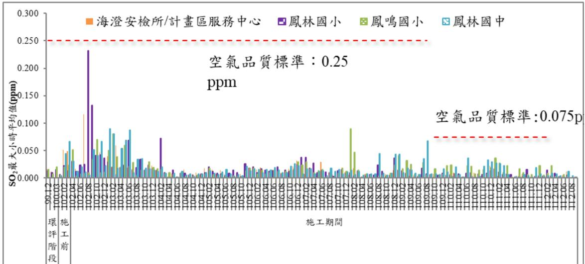
圖 4 歷次 SO<sub>2</sub>最大小時平均值監測結果比較圖
