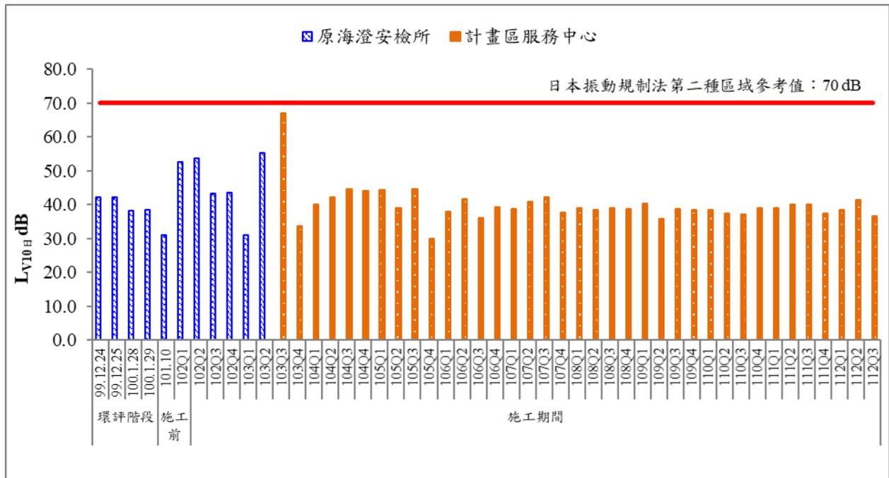
圖 19 歷次日間振動監測結果比較圖(一)
