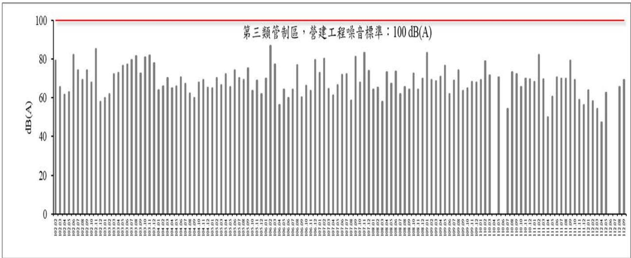
圖 27 歷次營建噪音  $L_{max}$  監測結果比較圖
