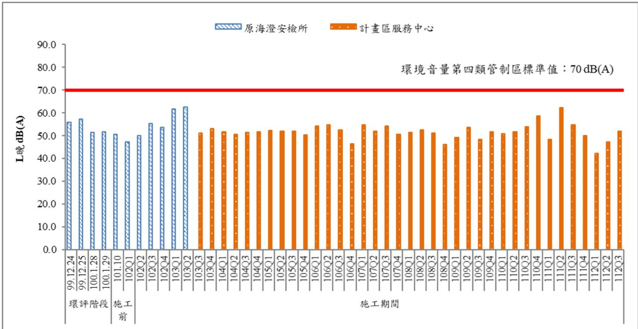
圖 15 歷次晚間噪音監測結果比較圖(一)
