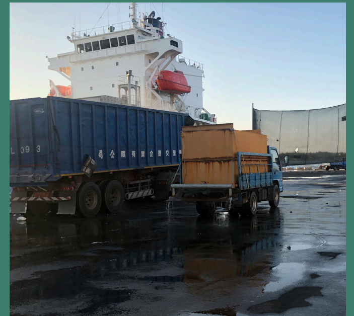
裝卸作業設置防塵網並加強灑水
